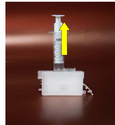
Фото 5. Выкачиваем воздух через подклапан
